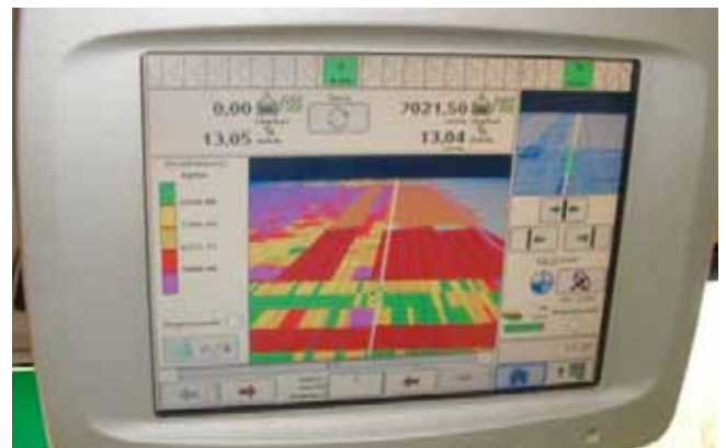
Figura 3: Monitores de rendimiento con información en pantalla utilizada por el operario y que luego quedará georreferenciada en el mapa de rendimiento.
