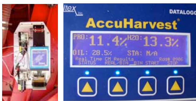
Figura 5: Sensor de calidad de grano ubicado en la noria de la cosechadora y monitor visualizador y registrador de datos.
