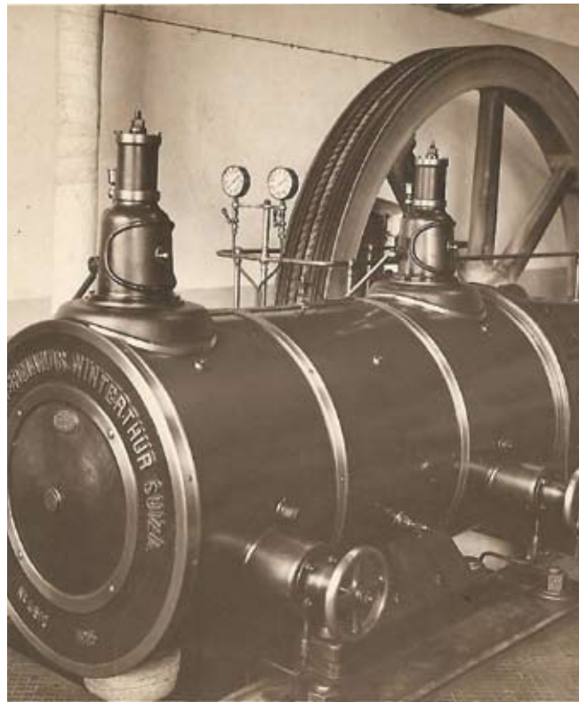
1915 – Motor de 150hp a vapor, proveniente de WINTERTHUR, SUIZA, fabricado Por SULZER HERMANOS. Aún se conserva en su lugar original.
