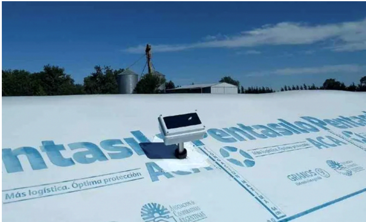
Foto 3: Sensor IoT para monitoreo de silos de Agrobait.
